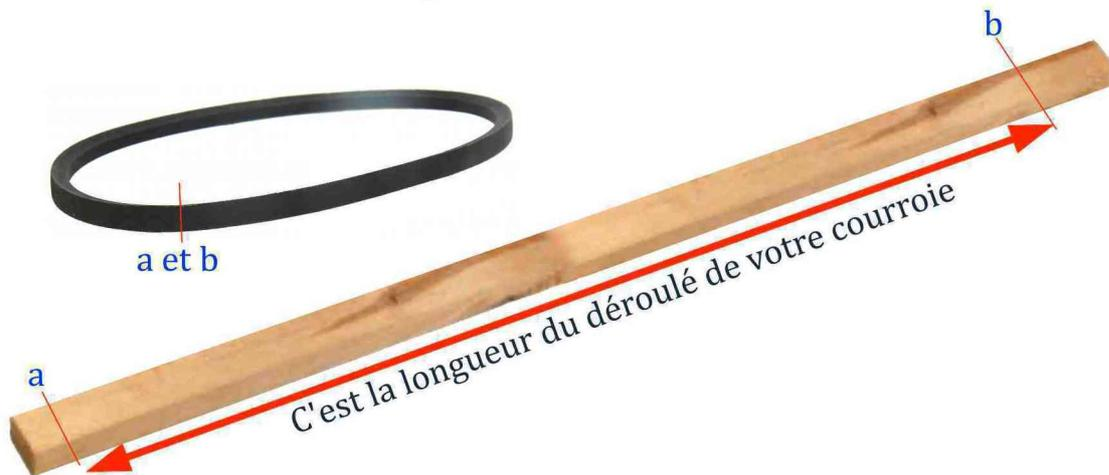
Par exemple : Courroie trapézoïdale lisse 13 mm x 8 mm dite "A". La longueur inscrite sur ce type de courroie varie selon les fabricants, il peut s'agir de la longueur intérieure (Li), de la longueur de référence (Ld, Lp) ou de la longueur extérieure (La, Le). Pour la déterminer si la référence est effacée, nous parlerons en mm et en longueur extérieure (sur le dos).
