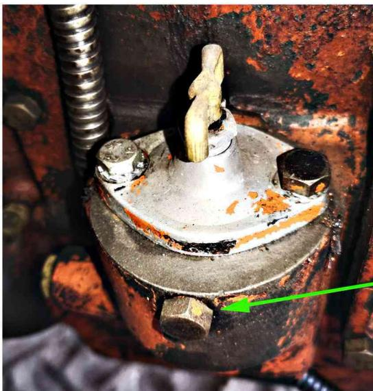
Vis de purge à utiliser après la vidange pour réamorcer le circuit de graissage (moteur 26)
