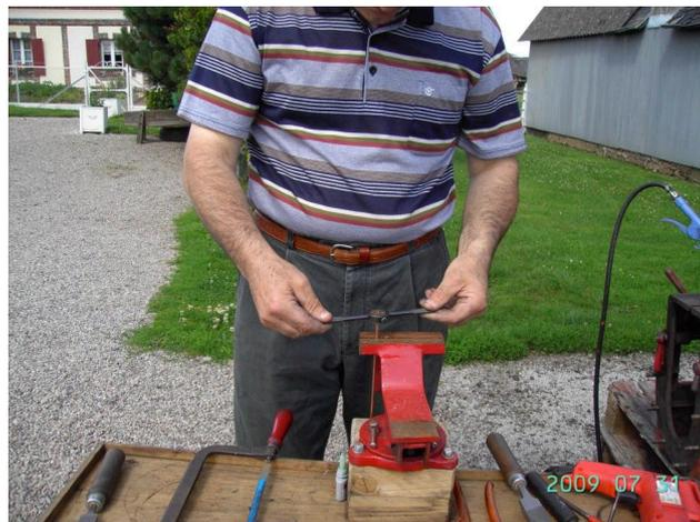
Fileter la tige de cuivre, en allant un peu plus loin que la profondeur de perçage effectuée dans le bloc.
