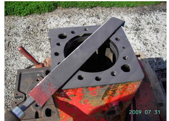
Bien enduire la surface du bloc avec de la pâte à roder, prendre une lime de 300 de la toile moyenne bien tendue sur la lime et procéder en faisant un mouvement en forme de 8. Changer de coin et continuer, pour finir pendre un peu d'huile moteur et bien lisser avant de nettoyer. Il faudra que la surface soit parfaite partout comme sur la photo. Après cette opération assez délicate, vous êtes prêt à monter la chemise avec son joint sans oublier la cale qui va sous celle-ci.
