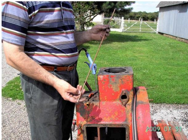
Après démontage, mauvaise surprise le bloc moteur est cassé à deux places. Il va falloir procéder à sa réparation par un point de chaînette.
